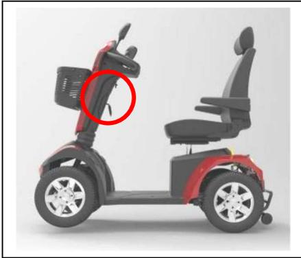
Die Lenkeinheit kann in viele verschiedene Positionen (stufenlos) passend für jeden Fahrer eingestellt werden.
