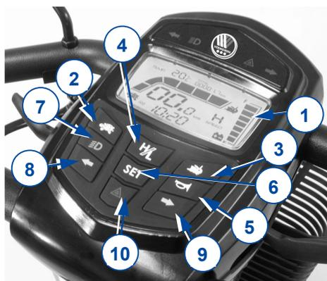
1. Akkuladezustandsanzeige / LCD-Anzeige
