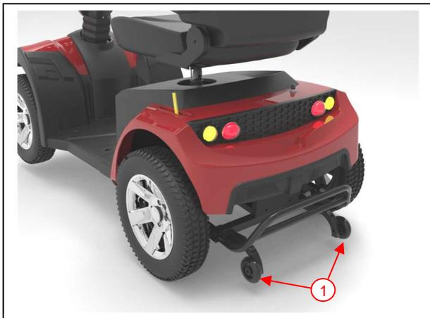
Am Rahmen des Scooters ist auf der Rückseite ein Kippschutz (1) befestigt. Dieser Kippschutz kann nicht entfernt werden. Er ist für Ihre Sicherheit da. Er verhindert, dass der Scooter nach hinten umkippt, wenn Sie über kleine Hindernisse fahren, die NICHT die maximale Höhe überschreiten, die in Abschnitt 5 angegeben ist.
