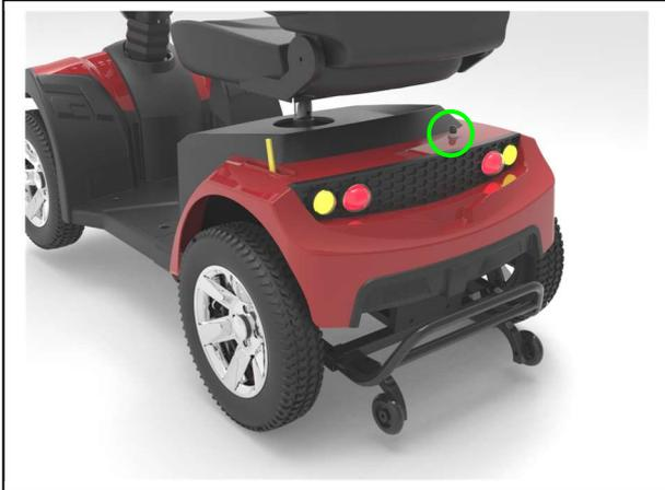
Um den Motor vor Überlastung zu schützen, hat Ihr Scooter auf der Rückseite einen thermischen Sicherheitsmechanismus. Die Thermosicherung schaltet den Motor automatisch ab, um eine Überhitzung und damit schnellen Verschleiß oder Ausfälle zu verhindern. Sie können die thermische Sicherheitsvorrichtung durch einen Spalt auf der Rückseite der Kunststoffabdeckung erreichen.
