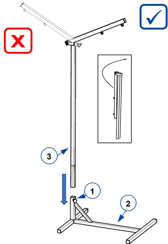
Die Aufrichtstange ③ mit dem Sternknopf ① in das Untergestell einsetzen und sichern. Die Aufrichtstange gemäß der Zeichnung in das Untergestell ② einsetzen und befestigen.
