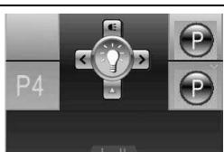
Para encender o apagar la luz de aviso, mueva el joystick hacia **abajo**.
