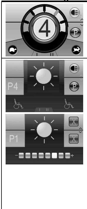
Wählen Sie die Programmfunction mithilfe der Feldauswahltaste (9) und im Display erscheint das Menu für die Sonderfunktionen.
