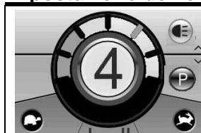
Selezionare la funzione di programma mediante il pulsante di selezione del campo (9) e sul display appare il menu per le funzioni speciali.
