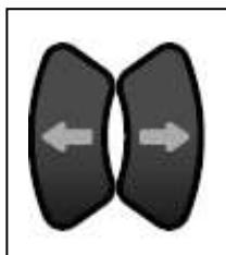
Aby poinformować o skręcie w lewo lub w prawo, naciśnij przycisk lewego lub prawego kierunkowskazu. Zacznie migać zielona dioda aktywowanego kierunkowskazu. Naciśnij ponownie przycisk kierunkowskazu, aby wyłączyć kierunkowskaz.
