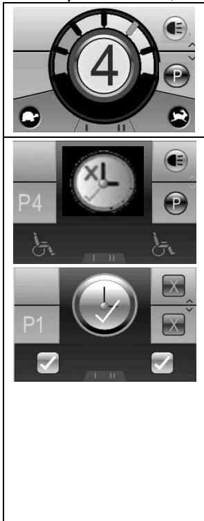
Wählen Sie die Programmfunction mithilfe der Feldauswahltaste (9) und im Display erscheint das Menu für die Sonderfunktionen.
