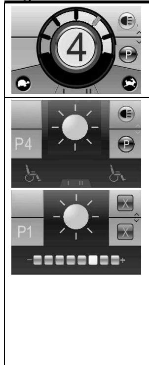
Selezionare la funzione di programma mediante il pulsante di selezione del campo (9) e sul display appare il menu per le funzioni speciali.
