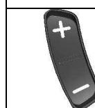
Wählen Sie im Fahrmodus mit der Fahrprofiltaste (8) ein höheres oder niedrigeres Fahrprogramm (Fahrprofil 1-5). Werkseitig sind diese Fahrprogramme aufsteigend von langsam bis schnell programmiert. In der Mitte des Displays wird das ausgewählte Fahrprogramm in roter Schrift angezeigt.
