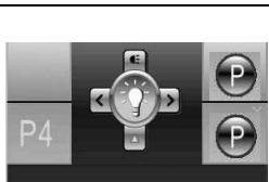
Para encender o apagar la luz, mueva el joystick hacia **arriba**.
