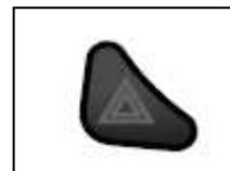
Om de waarschuwingsknipperlichten in te schakelen, drukt U op de knop voor de waarschuwingsknipperlichten. De twee linkse en rechtse richtingaanwijzers LEDs gaan gelijktijdig in het groen knipperen. Druk opnieuw op de knop voor de waarschuwingsknipperlichten om deze terug uit te schakelen.
