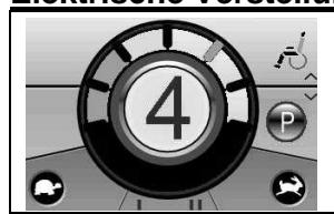
Wählen Sie die Programmfunction mithilfe der Feldauswaltaste (9) und im Display erscheint das Menu für die Verstellfunktionen.
