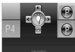
Beweeg de joystick naar links of rechts om de linkse of rechtse richtingsaanwijzer te activeren **links of rechts**.
