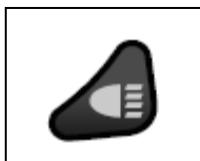
Om de lampen in te schakelen, drukt U op de knop voor de verlichting. De LED voor de lichten naast de verlichtingsknop gaat branden in een groene kleur. Druk opnieuw op de verlichtingsknop om de lampen terug uit te schakelen.
