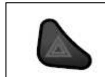
Zum Einschalten des Warnblinkers drücken Sie die Warnblinker-Taste. Die beiden grünen LED's für den linken und rechten Blinker blinken gleichzeitig. Zum Ausschalten des Warnblinkers drücken Sie die Warnblinker-Taste erneut.
