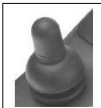
Przesuwanie joysticka spowoduje skierowanie elektrycznego wózka inwalidzkiego w danym kierunku. Stopień wychylenia joysticka określa prędkość, z jaką wózek będzie się przemieszczał w danym kierunku.
