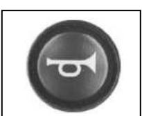
Drücken Sie die Taste mit dem Signalhorn. Der Signaltion ertönt so lange, wie die Taste gedrückt wird.
