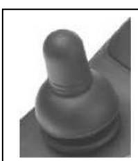
Durch Bewegen des Joysticks in eine Richtung fährt der Elektro-Rollstuhl in die vorgegebene Richtung. Der Betrag der Joystick-Bewegung bestimmt die Geschwindigkeit, mit der sich der Elektro-Rollstuhl in diese Richtung bewegt.
