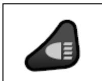
Para encender los faros, pulse el botón del faro. El LED verde situado al lado del botón se iluminará. Pulse de nuevo el botón de los faros para apagarlos.
