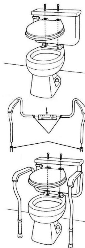
3. Setzen Sie den Toilettensitz wieder auf die Toilettenschüssel und richten sie auch diese Bohrungen genau über-einander aus.
