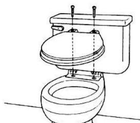
2. Posizionare la guida di fissaggio sul wc e allineare i fori.
