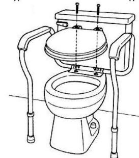
5. Far scorrere il tubo delle maniglie di appoggio nelle gambe e fissare il tutto tramite i pulsanti a pressione.
