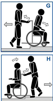
1. Die Begleitperson dreht den Rollstuhl so um, dass sich die Hinterräder zuerst der Bordkante nähern (G/H).
