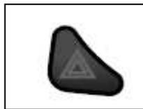
Zum Einschalten des Warnblinkers drücken Sie die Warnblinker-Taste. Die beiden grünen LED's für den linken und rechten Blinker blinken gleichzeitig. Zum Ausschalten des Warnblinkers drücken Sie die Warnblinker-Taste erneut.
