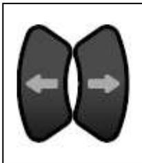
Zum Anzeigen eines Fahrtrichtungswechsels nach links oder rechts drücken Sie die linke oder rechte Fahrtrichtungsanzeige-Taste. Die grüne aktivierte LED für die Fahrtrichtungsanzeige blinkt. Drücken Sie die Taste erneut, um die Blinker wieder auszuschalten.
