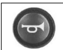
Drücken Sie die Taste mit dem Signalhorn. Der Signalton ertönt so lange, wie die Taste gedrückt wird.
