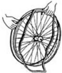
Schieben Sie das Felgenband über das Schlauchventil und stecken Sie dieses dann in die Felge. Jetzt lässt sich das Felgenband mühelos aufziehen. Überprüfen Sie, ob alle Speichenköpfe abgedeckt sind (Bei Verwendung von Kunststofffelgen wird kein Felgenband eingesetzt).
