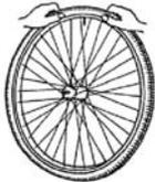
Wenn der Schlauch problemlos und ohne Einknickungen in den Reifen passt (falls Einknickungen auftreten: lassen Sie etwas Luft aus dem Schlauch ab), können Sie die obere Seite des Reifens mit beiden Händen leicht auf die Felge drücken. Beginnen Sie dabei am Luftventil.
