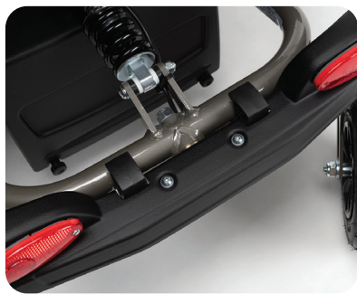
Die Pendelachse sichert die Fahrstabilität
