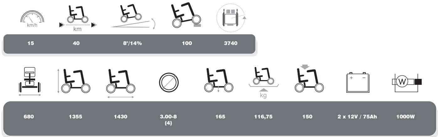
Abweichungen bei Maßen und Gewichten (1,5 cm und 1,5 kg) sind möglich. Reichweite unter optimalen Umgebungsbedingungen und Batteriezuständen ermittelt nach ISO 7176-4.
