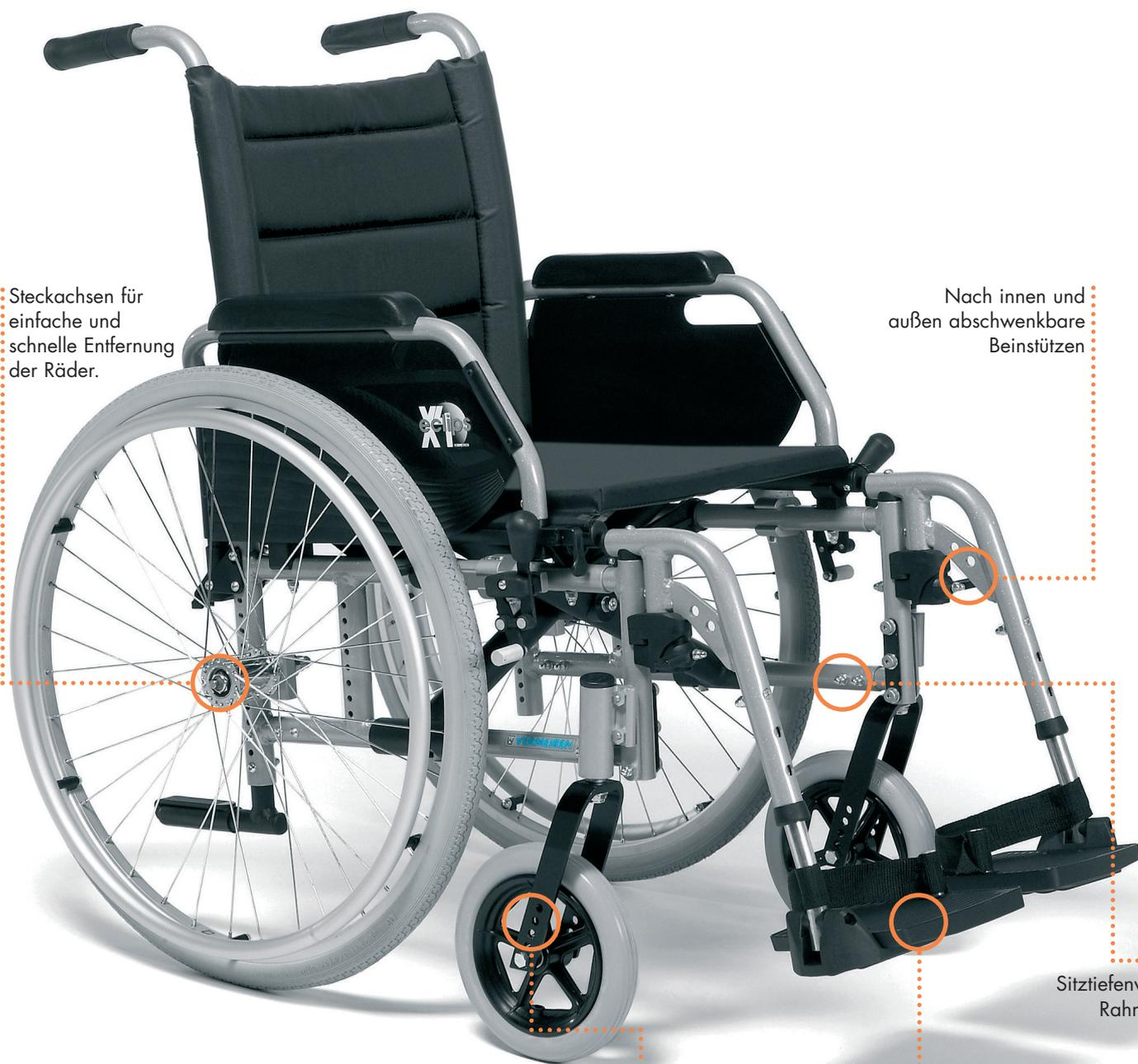
Aluminiumgabeln verringern das Gewicht des Rollstuhls - die Befestigungshöhe ist veränderbar. Die Lenkräder können in verschiedenen Höhen angebracht werden.
