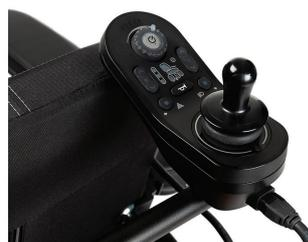
**SE08** Haltevorrichtung für zusätzliche Steuerung
