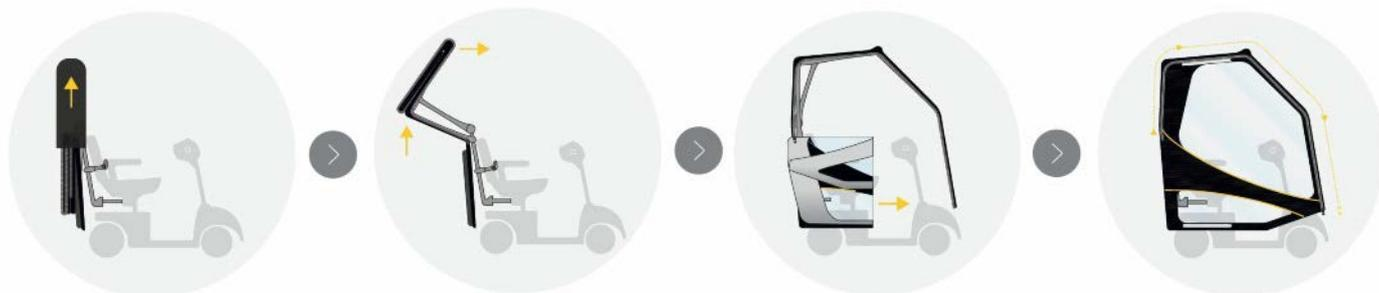
Die Montage ist einfach ! Schieben Sie die Halterung des Wetterdachs in die Zubehöraufnahme des Sitzes am Scooter und befestigen die verstellbaren Seitenteile des Daches an den Armlehnen des Scooters.
